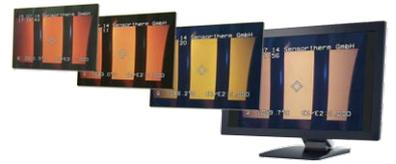
**彩色相机模块** 提供复合视频输出，可连接到视频监视器或通过视频采集卡连接到PC。高温计通过TV屏幕上的一个圆形标识对准。该瞄准方式推荐用于远程观察发光的热目标或通过窥视管向下瞄准目标。相机模块提供自动、高度动态的亮度调整功能。
