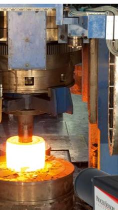
**取景器** 提供了直观的图像，这样被测目标可以很容易地被观察到。其中的圆形标识用于指示测量温度点。建议取景器用于有光亮的目标瞄准，这种情况下采用激光瞄准的话，红色激光很难识别。对于上限温度超出1800°C的型号，目镜可以调暗以保护眼睛不受损害。
