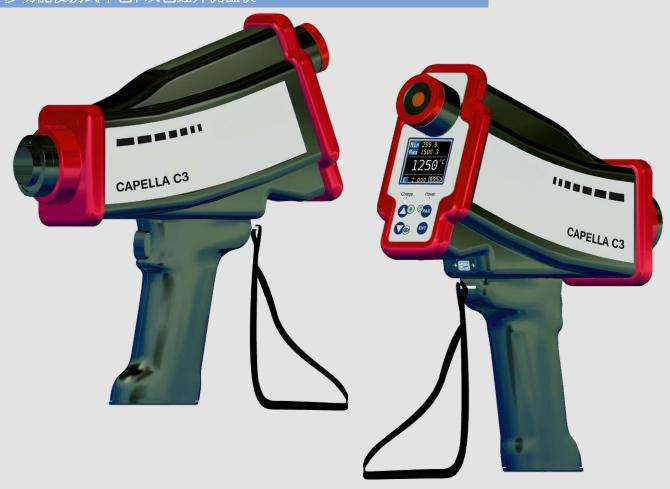
非接触, 手持式, 短波红外测温仪, 特别适用于明亮金属表面温度测试.
