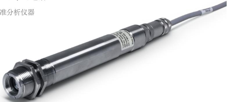
IMPAC IGAR 320 是一款固定式，紧凑型，双色快速响应的用于非接触测量的高温计。高温计采用双色测温原理(比值法)，利用两个相邻波段辐射能量的比值进行测温。
