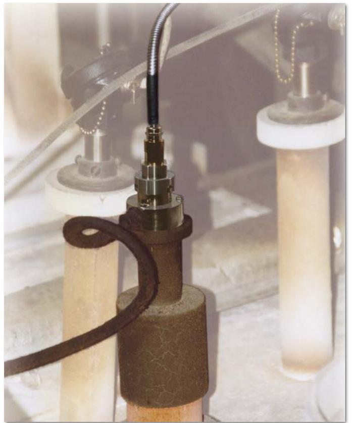
高温计 **IS 50-LO/GL** 专为玻璃工业设计. 适用于玻璃窑炉, 工作部, 料道和供料机的温度测量. 此外还可用于蓄热室和窑炉砖砌体的测温.
