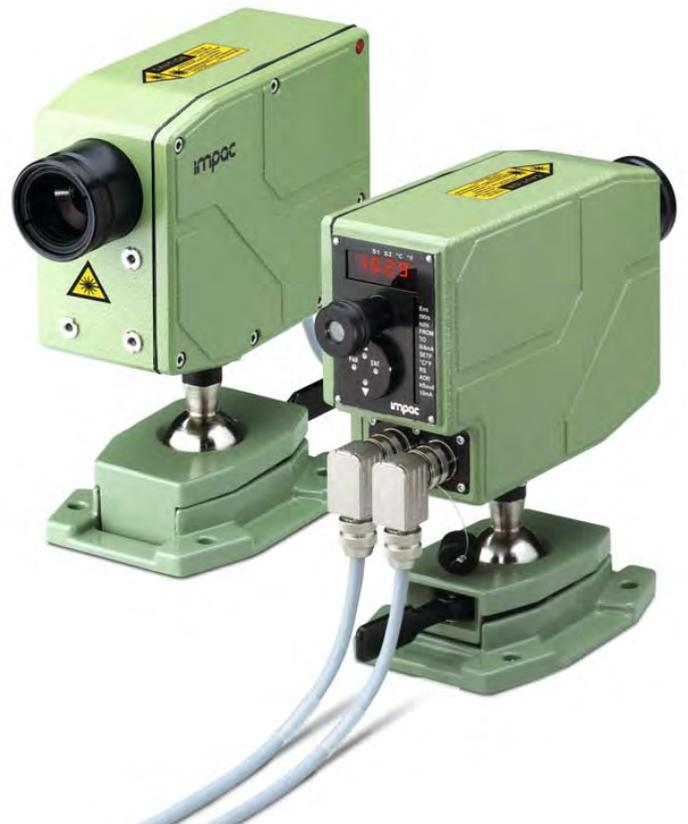
**IS 12-Si** 是在 **IS 12** 基础上开发的，专用于硅晶圆温度测量的高温计。
