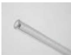
保护光导管的蓝宝石或石英护套
