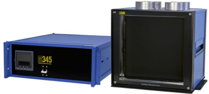
黑体辐射源用于校检红外测温仪(高温计)，热成像系统，热流量计或光谱分析系统。MIKRON 提供可溯源至国家标准的高精度辐射源。
