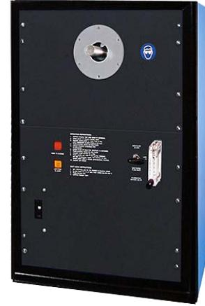
黑体炉用于校检红外测温仪(高温计)，热成像系统，热流量计或光谱分析系统。MIKRON 提供可溯源至国家标准的高精度黑体炉。
