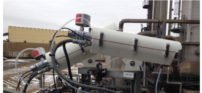
ThermalSpection 保护套。电源线，通讯线，以及空气吹扫连接部分都覆盖了软管。
