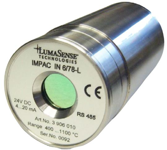
IN 6/78-L是一款专为极薄玻璃表面非接触式温度测量设计的测温仪。其特殊的7.8 μm波长能够准确可靠地测量低于1mm厚度（超薄玻璃）的玻璃温度。正因为如此，其为全球超薄玻璃生产提供了全新的标准和解决方案。
